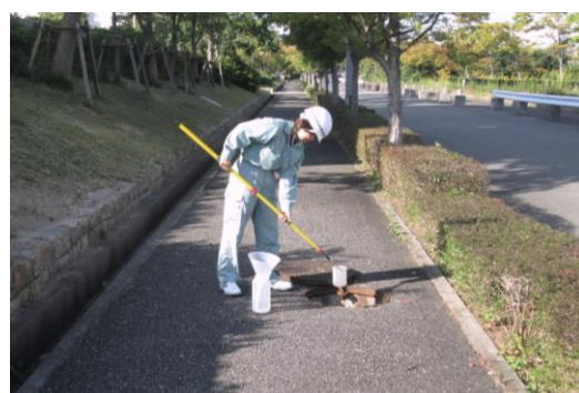
汚水幹線での監視（採水）
