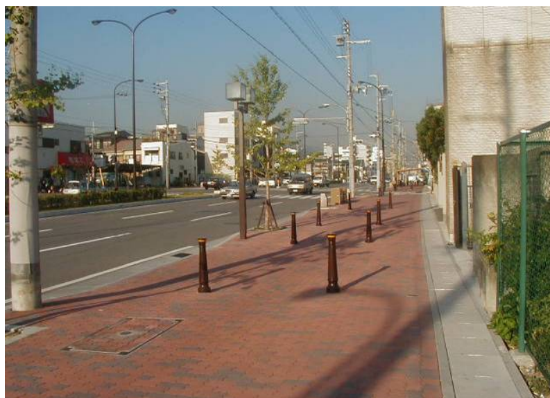
写真2-3-4 横断方向へのボラード等の設置例
