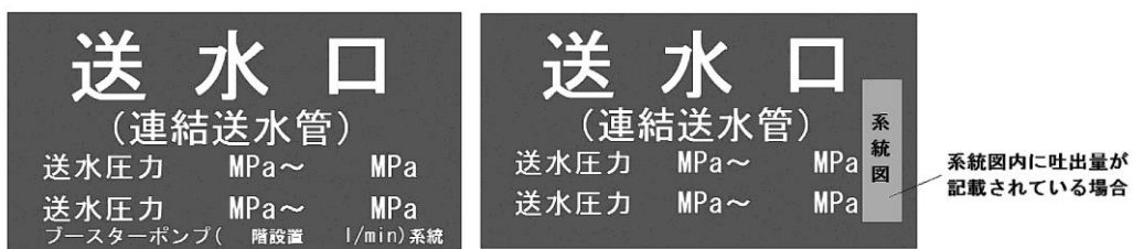
第21-6図 加圧送水装置が設置されている連結送水管の標示例
