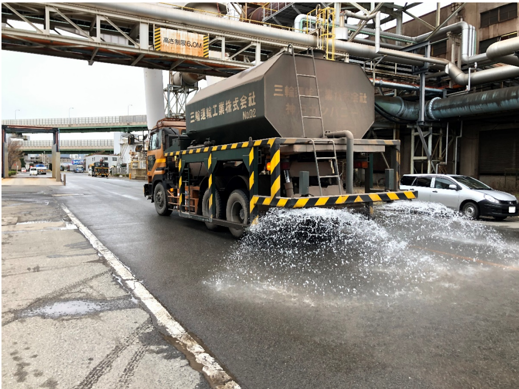
写真 4. 1-1 平成 30 年度における車両洗浄及び道路散水の実施状況
