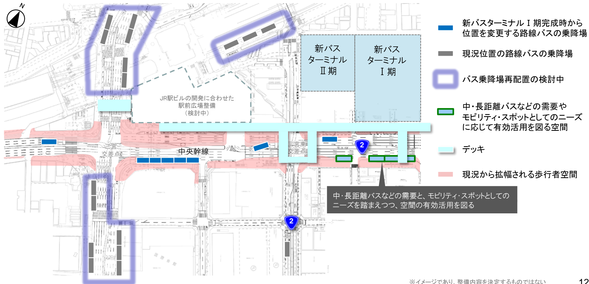
■ 新バスターミナルⅡ期完成時におけるバス乗降場およびモビリティ・スポットの配置計画（案）
