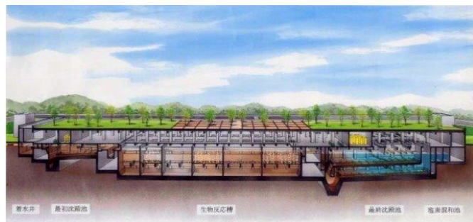
高度処理施設の導入事例（垂水処理場）
