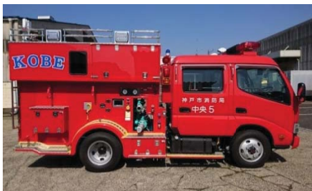
資材搬送ポンプ車
