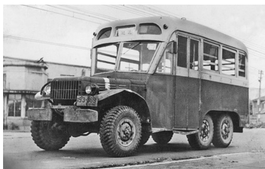
米軍から払い下げられたダッジ・ブラザーズ改造バス
