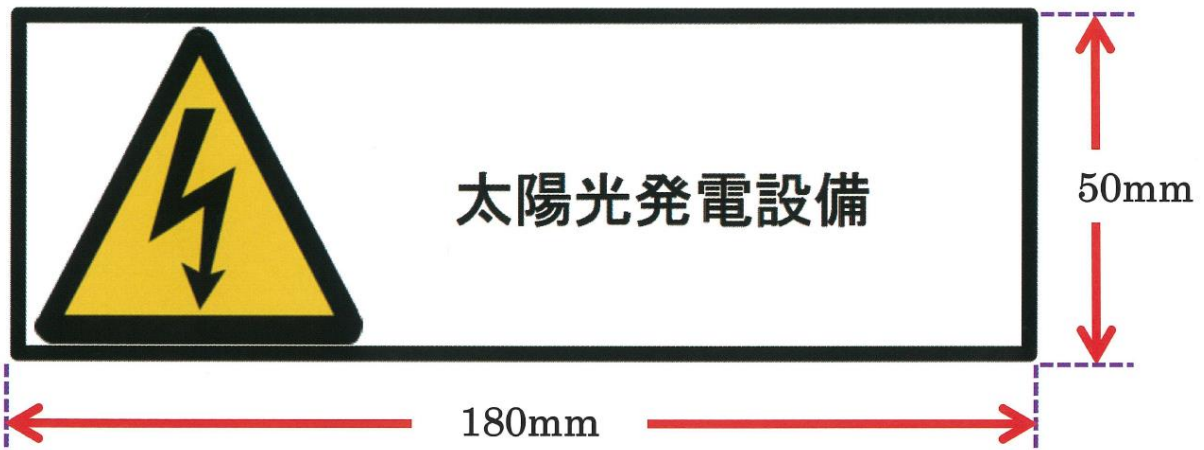
【 第17-4表 太陽光発電設備における表示 】
