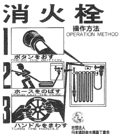
第2-16図 1号消火栓の使用法表示例(1)
