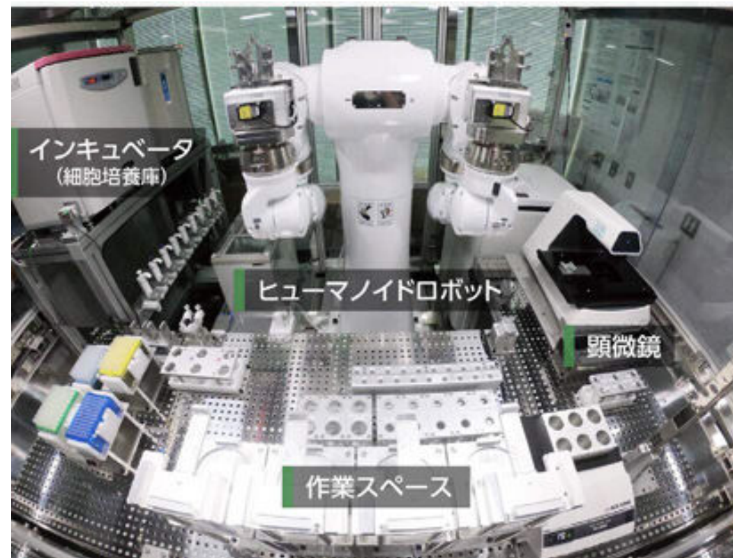
高精度な生命科学実験動作が可能な汎用ヒト型ロボットLabDroid「まほろ」
