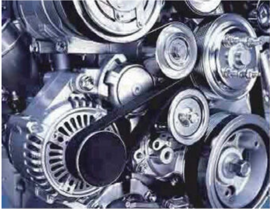
自動車補機駆動用伝動ベルト
