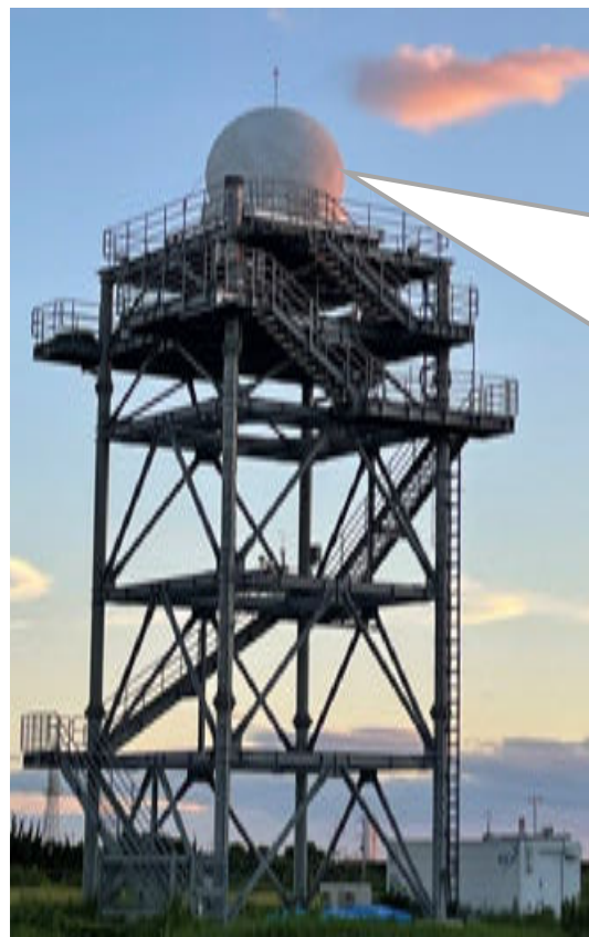
未来ICT研究所(神戸)に新設されたマルチパラメーターフェーズドアレイ気象レーダー(略称:MP-PAWR)
