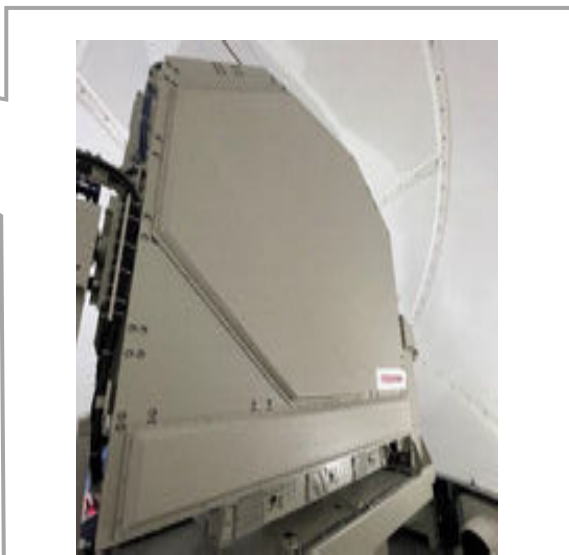
鉄塔の上のレドーム内に設置されたレーダーのアンテナ部
