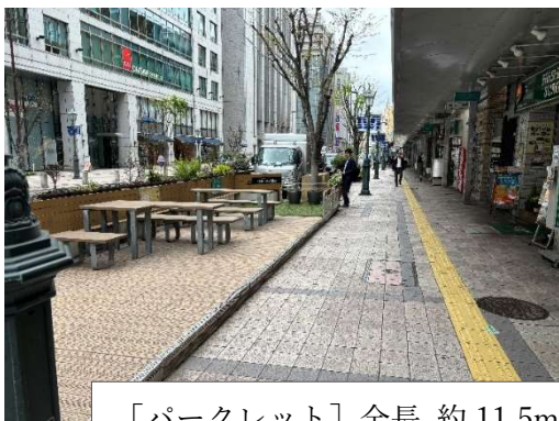
[パークレット] 全長 約 11.5m、全幅 約 2 m [歩道幅員] 約 3 m
