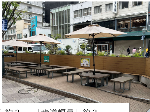
[パークレット] 全長 約 11.5m、全幅 約 2 m [歩道幅員] 約 3 m
