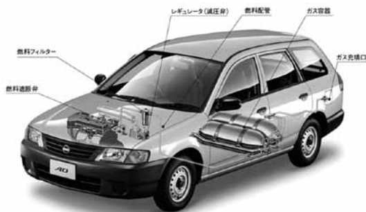
図2 CNG車のしくみ
